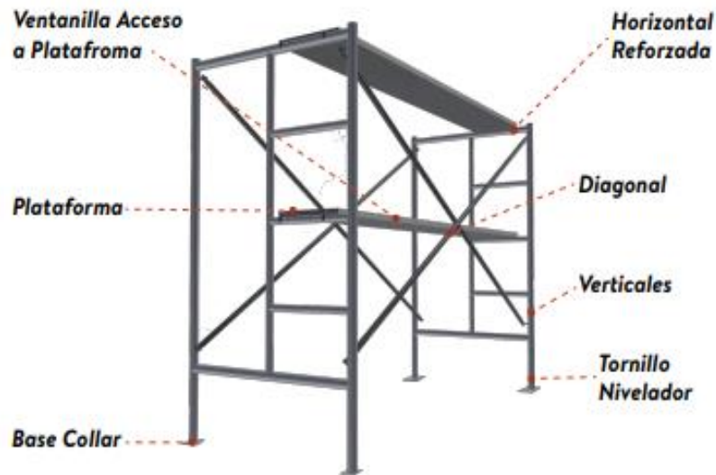
Figura 22. Descripción de partes de andamio
