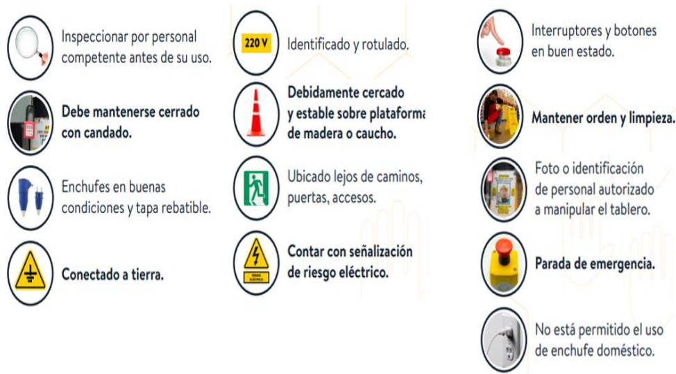
Figura 26. Requerimientos de tableros provisionales
